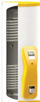
Bollitore solare compatto con centralina WCR1 e stazione solare integrate - rivestimento in ABS - spessore isolamento 50mm ( $\lambda=0,024$  W/mK). Stazione solare due vie monoblocco, integrata nell'isolamento del bollitore, completa di: valvola di sfiato, rubinetti di caricamento/sfiato, valvola di non ritorno, gruppo di sicurezza e pompa elettronica ad alta efficienza. **CLASSE ENERGETICA C.**
