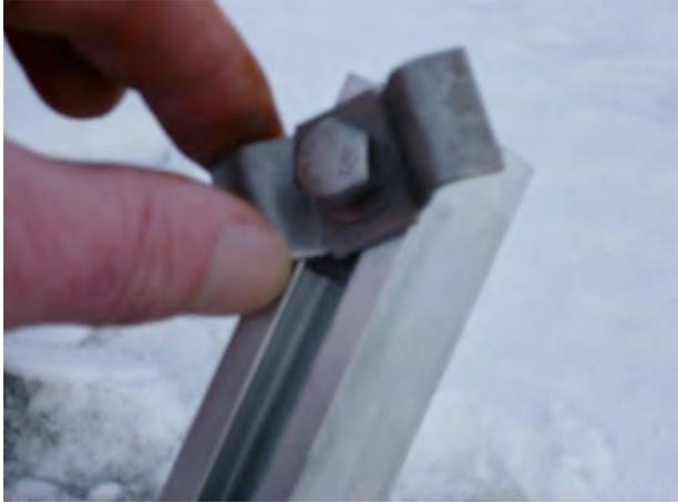
Die mitgelieferten Metallklammern mit der Gleitmutter in das Montageprofil einführen.
