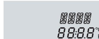
Die Kanalanzeige besteht aus 2 Zeilen. In der oberen 16-Segment-Anzeige werden hauptsächlich Kanalnamen/Menüpunkte eingeblendet. In der unteren 16-Segment-Anzeige werden Werte angezeigt.
