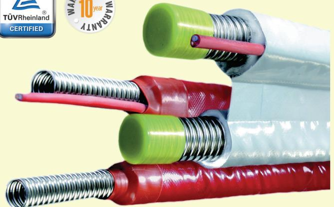
Aerogel WSolar Energie Lösungen sind ein komplettes System von vorgedämmten Doppelrohren für Solaranlagen. Die Basis ist ein gewelltes Stahl-Bi-Rohr aus rostfreiem Stahl, hergestellt nach der europäischen Norm 1.4404/AISI 316L. Ein besonderes Merkmal der Aerogel-Rohre ist ihre Aerogel-Dämmung, die sich durch einen extrem niedrigen Wärmeübergangskoeffizient (0,017 W/(m·K) bei einer Durchschnittstemperatur von 10°C gemäß PN-EN 12667: 2002).
